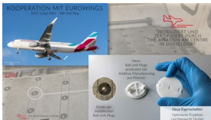
Abbildung 16: 3D-gedruckte Polymerkomponente (Ball Unit Plugs) der THE AVIATION AM CENTRE GmbH
