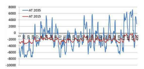
Abbildung 3: Beispiel für den ermittelten Stromaustausch zwischen Deutschland und einem benachbarten Land in einem prototypischen Jahr
